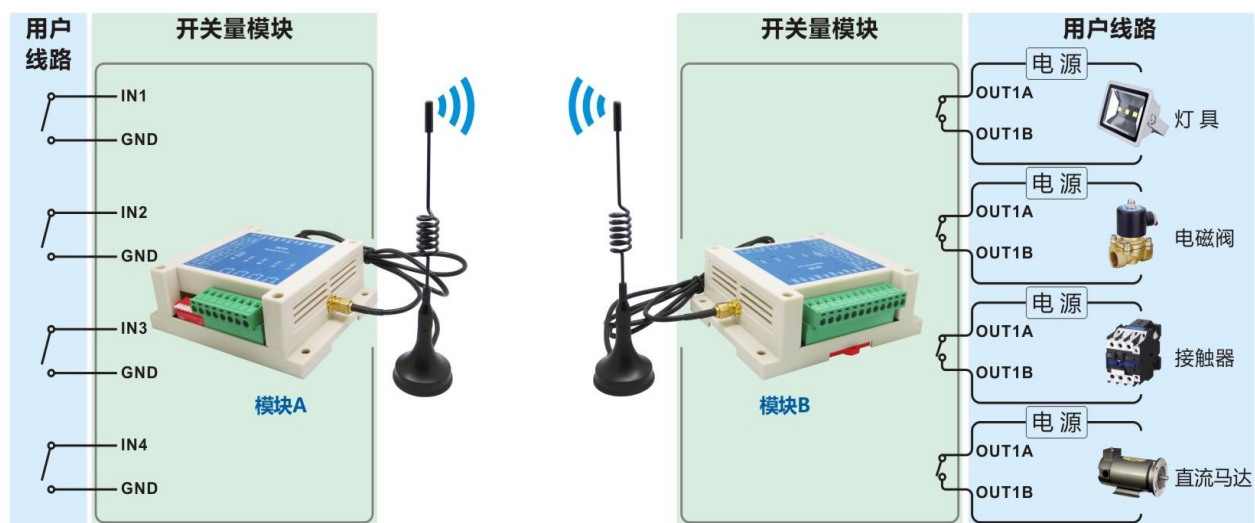
模块A的输入INx与GND短接，模块B的OUTx继电器便吸合；模块A的输入INx与GND断开（或悬空），模块B的OUTx继电器便断开。
